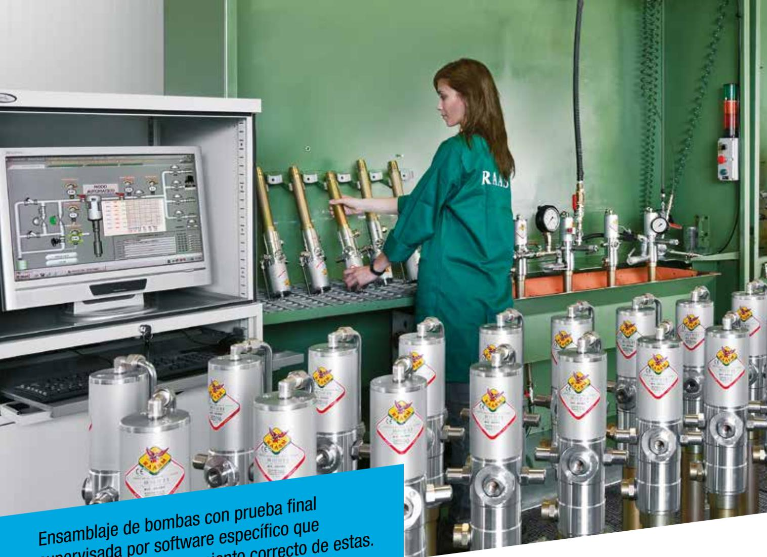
Ensamblaje de bombas con prueba final supervisada por software específico que comprueba el funcionamiento correcto de estas.
