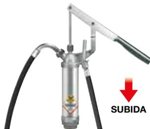
El doble efecto (Fig. 2) se da cuando el pistón de bombeo permite el suministro del fluido en el curso de ambos movimientos de subida y bajada. El doble efecto permite el suministro del fluido con flujo continuo y constante
