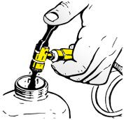
Antes de la purga es importante llenar la cuba de aceite de frenos usando el empalme rápido del purga frenos.
