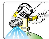
La presión del aire para una despresurización correcta es de entre **6,5 y 7 bar**
