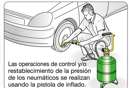
Las operaciones de control y/o restablecimiento de la presión de los neumáticos se realizan usando la pistola de inflado.
