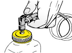
Conecte el equipo purga frenos a la cuba mediante el empalme rápido.
